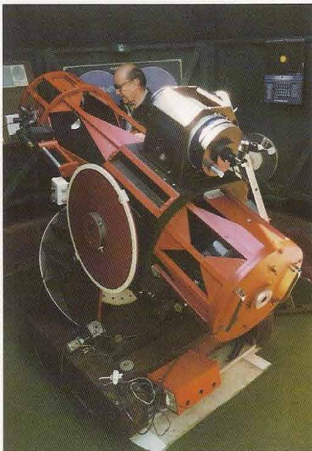
Altra vista dello strumento dal lato posteriore. Sono visibili uno strumento Schmidt-Cassegrain sussidiario, il cerchio di declinazione e, in basso, il variatore di frequenza. Lo specchio, di cui si intravede lo spessore, è sostenuto da un'apposita struttura con asse centrale basculante e scorrevole al centro della culatta. Quest'ultima è estraibile come la torretta girevole superiore.
