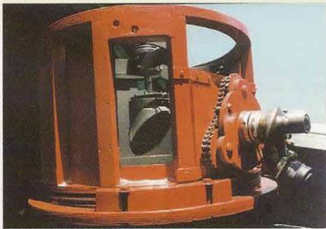
Qui sotto: Particolare della torretta girevole del telescopio. Si vedono lo specchio secondario e il sistema di messa a fuoco a più oculari.
